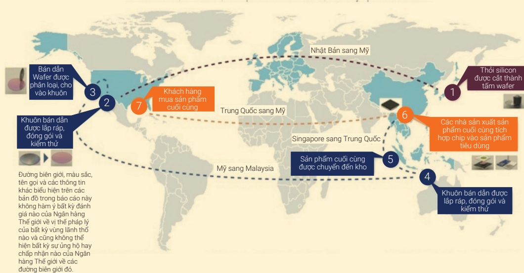
Hình B1.1: Quy trình sản xuất vi mạch bán dẫn tiêu biểu kéo dài từ 4-6 tháng với 3+ chuyến đi vòng quanh thế giới
