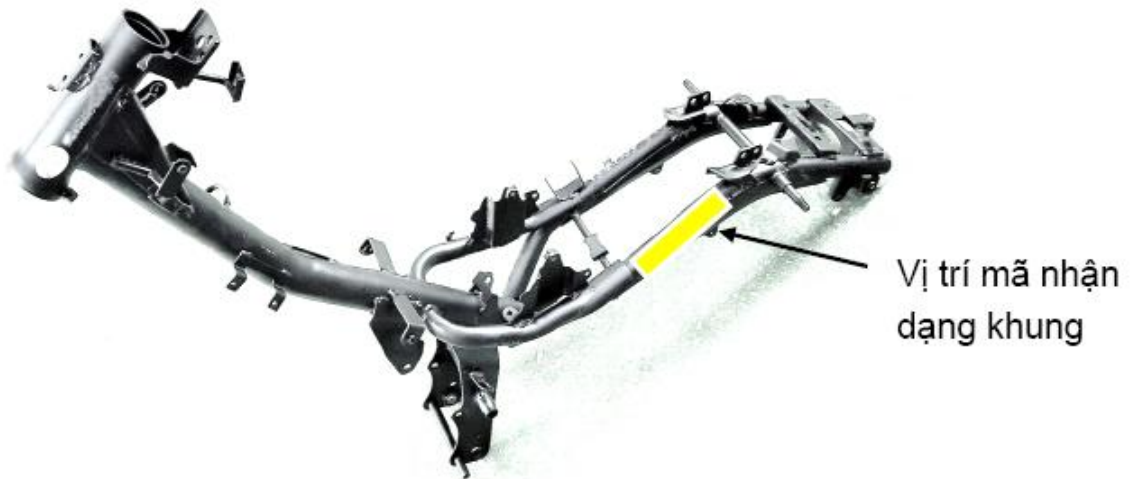
Hình minh họa ảnh chụp khung và vị trí mã nhận dạng khung
